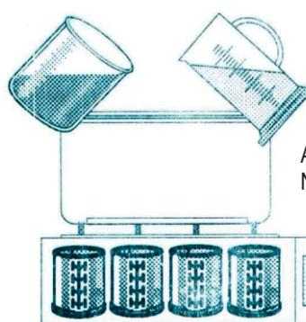
ADICIONE A ÁGUA E O REVESTIMENTO NO MISTURADOR A VÁCUO.
